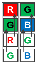
图 8-42 彩色相机垂直 Binning 系数为 2
