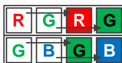
图 8-41 彩色相机水平 Binning 系数为 2
