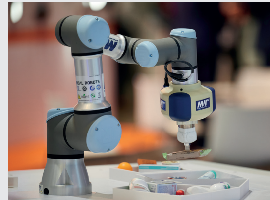
HALCON 的 3D 抓取点检测能够稳健地检测任何物体上适合用吸力抓取的面
