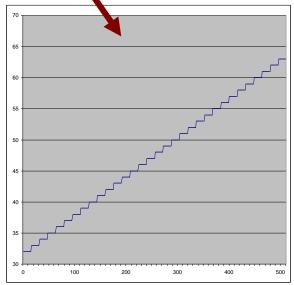
Pixel 0 : 32 Pixel 1 : 32 ... Pixel 15 : 32 Pixel 16 : 33 Pixel 17:33 ... Pixel 31 : 33 Pixel 32 : 34 .... Pixel 511 : 63 Pixel 512 : 96 Pixel 513 : 96 ... Pixel 2047 : 255 Pixel 2048 : 32 ...
