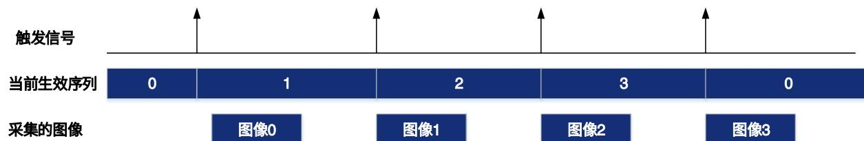
图 8-84 当前生效序列与触发信号和采集图像的关系
