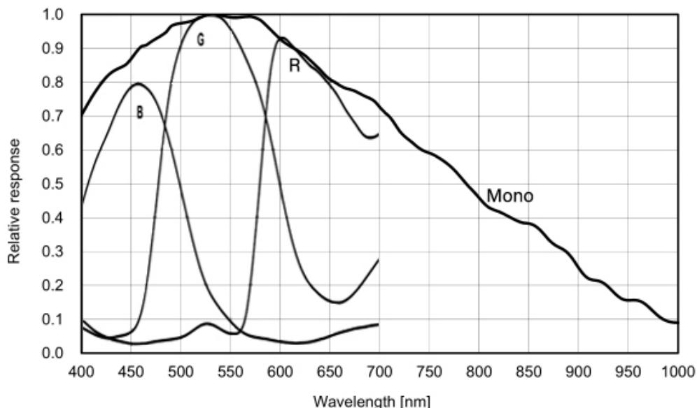
图 4-17 MER2-2000-19U3M/C(-L/-W90/-W90-S90) SENSOR 响应曲线
