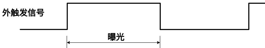
图 8-28 上升沿触发宽度曝光模式时序图
