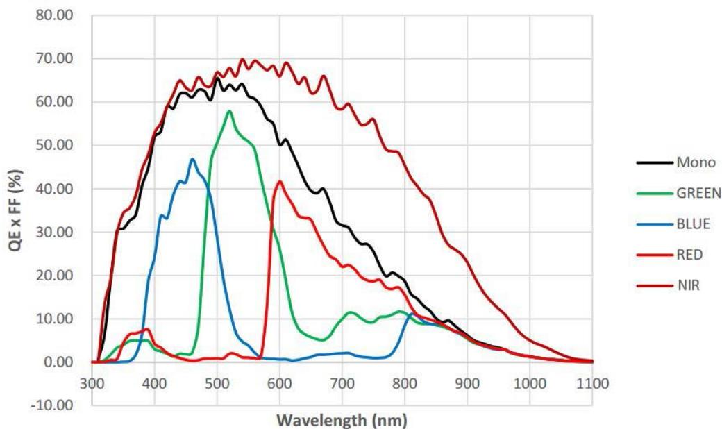
图 4-33 ME2P-2621-15U3M/C \ ME2P-2622-15U3M/C SENSOR 响应曲线
