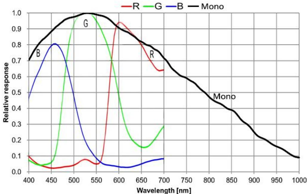
图 4-15 MER2-630-60U3M/C(-L/-W90/-W90-S90) SENSOR 响应曲线
