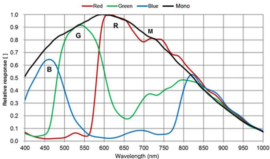
图 4-38 ME2P-1230-30U3M/C-HS SENSOR 响应曲线
