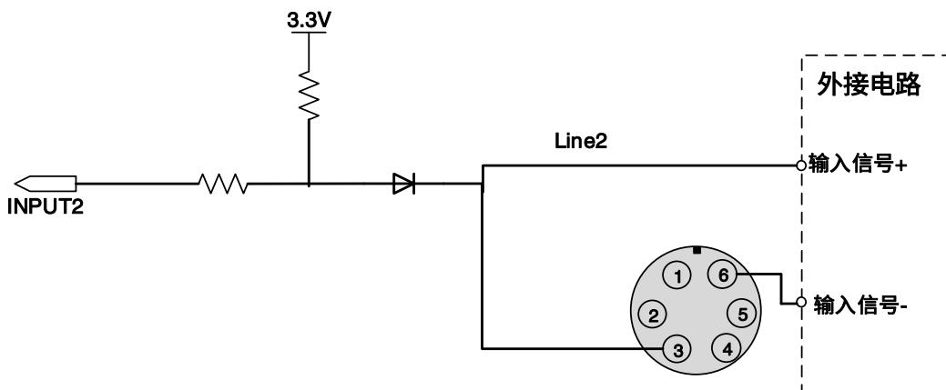
图 7-16 Line2 配置为输入引脚时相机内部等效电路 (ME2S)
