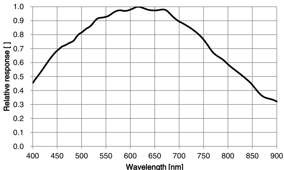
图 4-12 MER2-502-79U3M POL SENSOR 响应曲线
