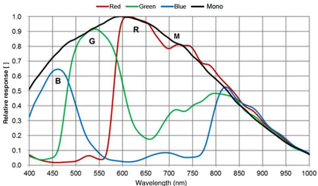
图 4-31 ME2P-1231-32U3M/C SENSOR 响应曲线
