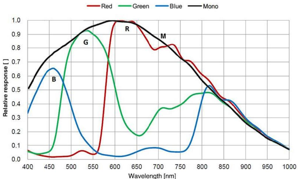
图 4-13 MER2-503-36U3M/C(-L) SENSOR 响应曲线
