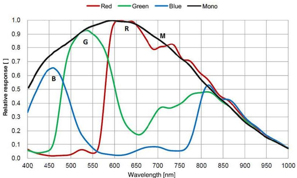
图 4-20 MER2-301-125U3M/C(-L)-HS SENSOR 响应曲线
