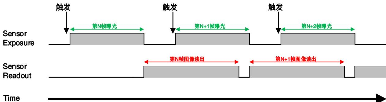
图 8-25 交叠曝光模式下触发采集曝光时序图
