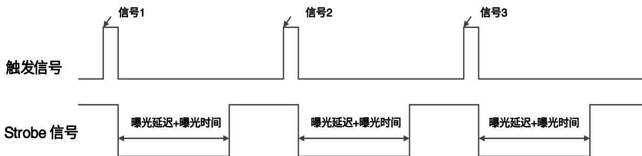
图 8-4 Strobe 信号示意图 (Global shutter、Global Reset Release shutter)
