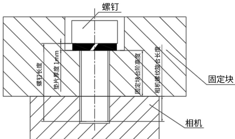
图 5-12 螺钉规格、固定块台阶厚度、弹垫厚度关系图
