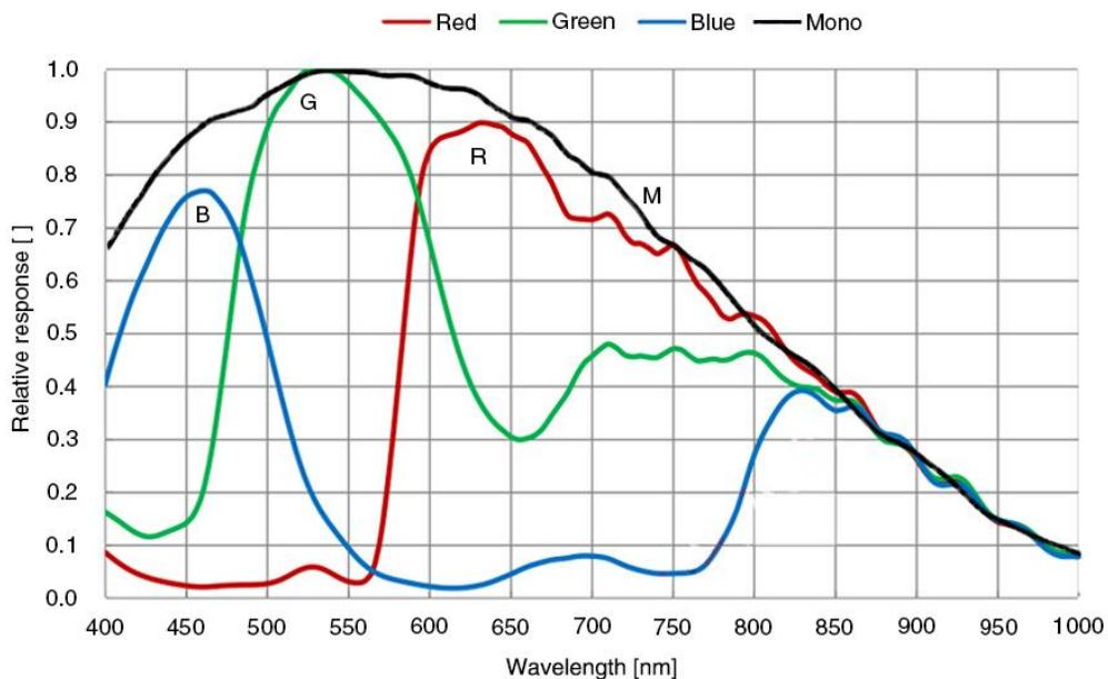
图 4-25 ME2S-1610-24U3M/C SENSOR 响应曲线
