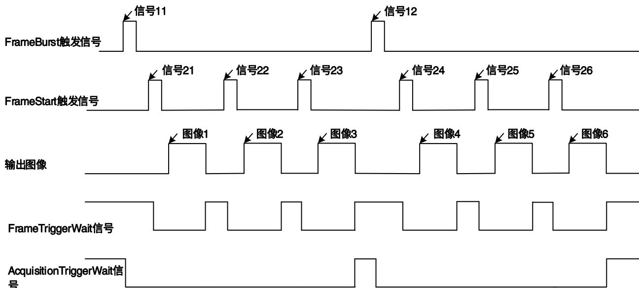
图 8-11 FrameBurstStart、FrameStart 同时使能时 TriggerWait 信号示意图
