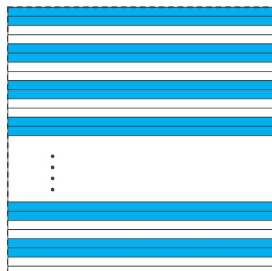
图 8-51 彩色相机垂直像素抽样原理
