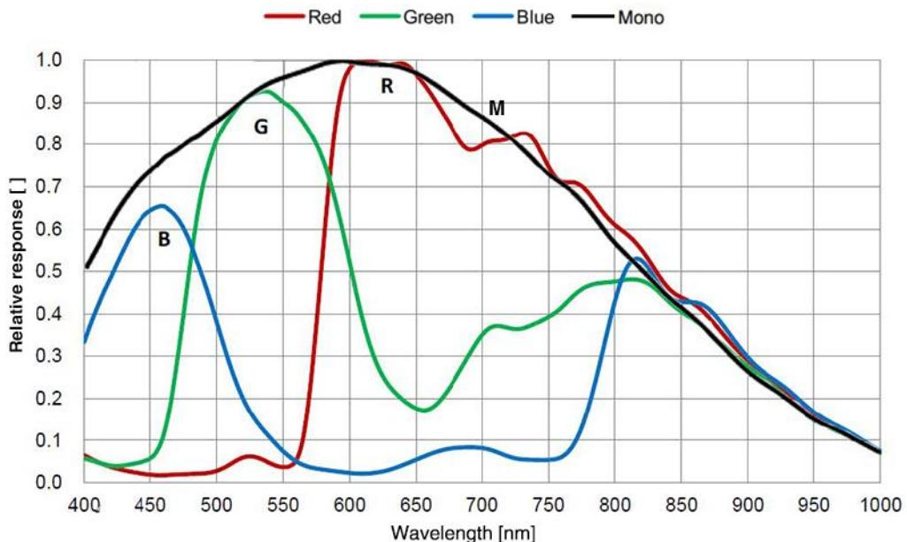
图 4-9 MER2-301-125U3M/C(-L) SENSOR 响应曲线
