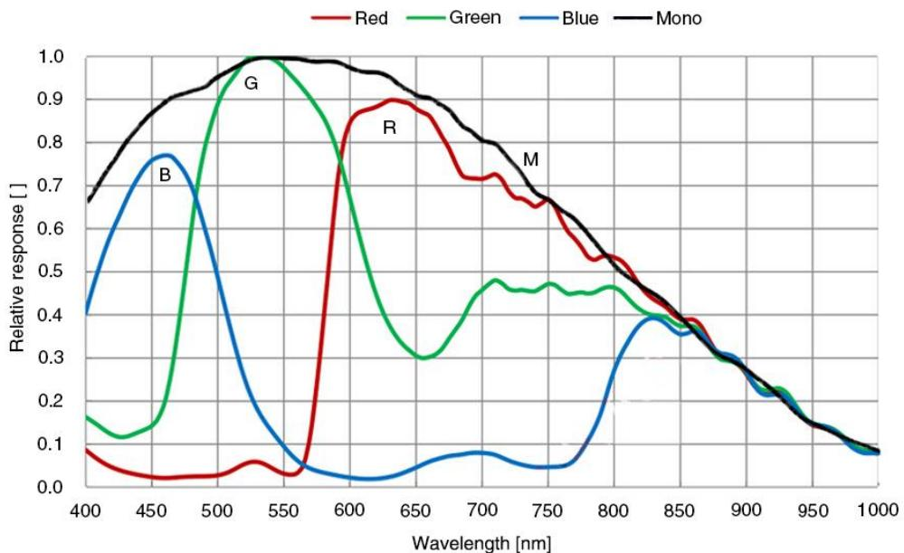
图 4-27 ME2S-2440-16U3M/C SENSOR 响应曲线
