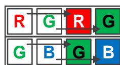
图 8-46 彩色相机水平 Binning 系数为 2
