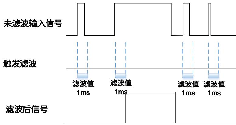
图 8-1 输入信号滤波示意图
