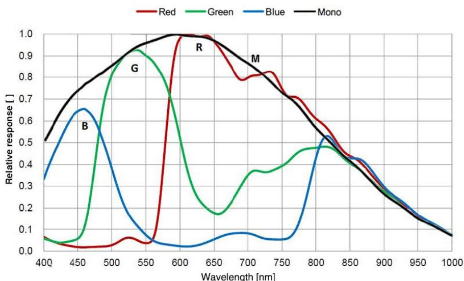
图 4-10 MER2-302-56U3M/C(-L) SENSOR 响应曲线
