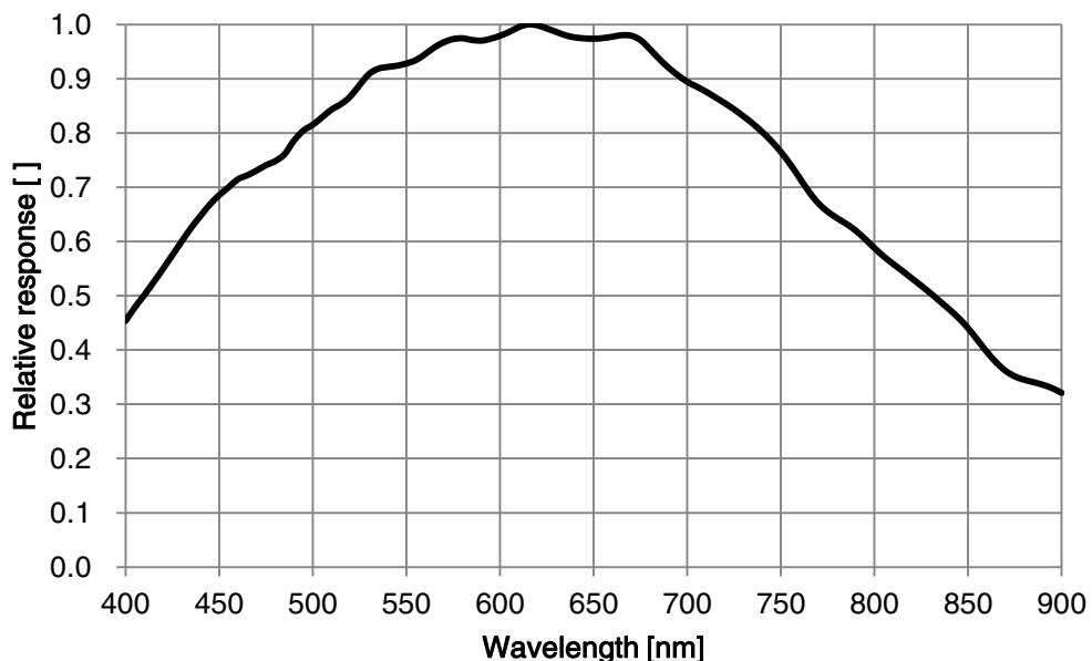
图 4-14 MER2-503-36U3M POL SENSOR 响应曲线
