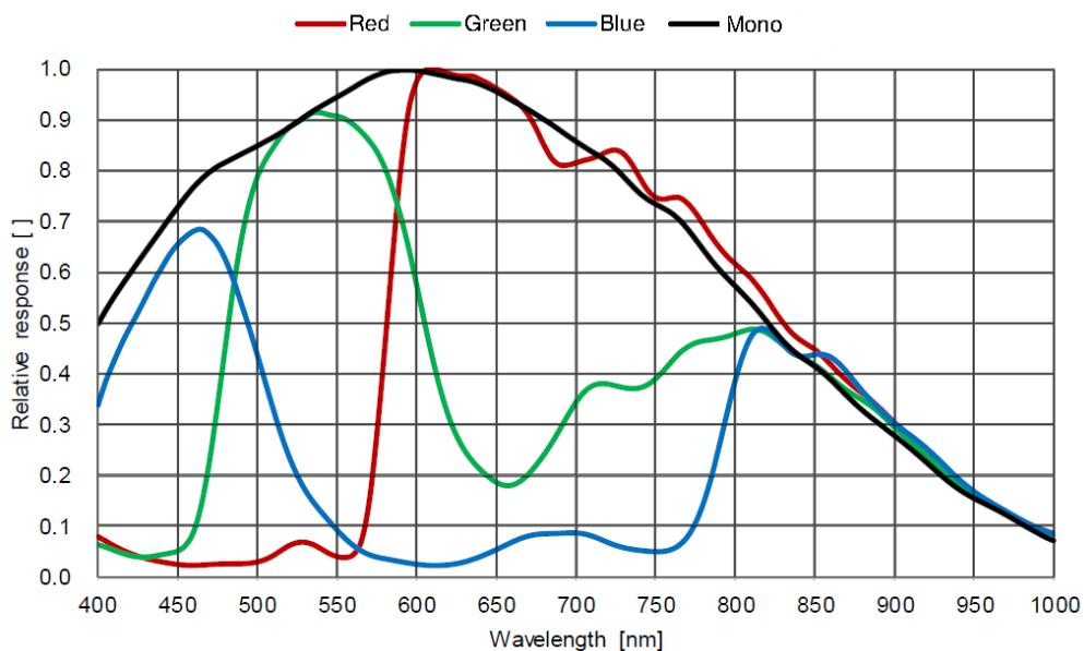
图 4-39 ME2L-042-121U3M/C(-L) SENSOR 响应曲线
