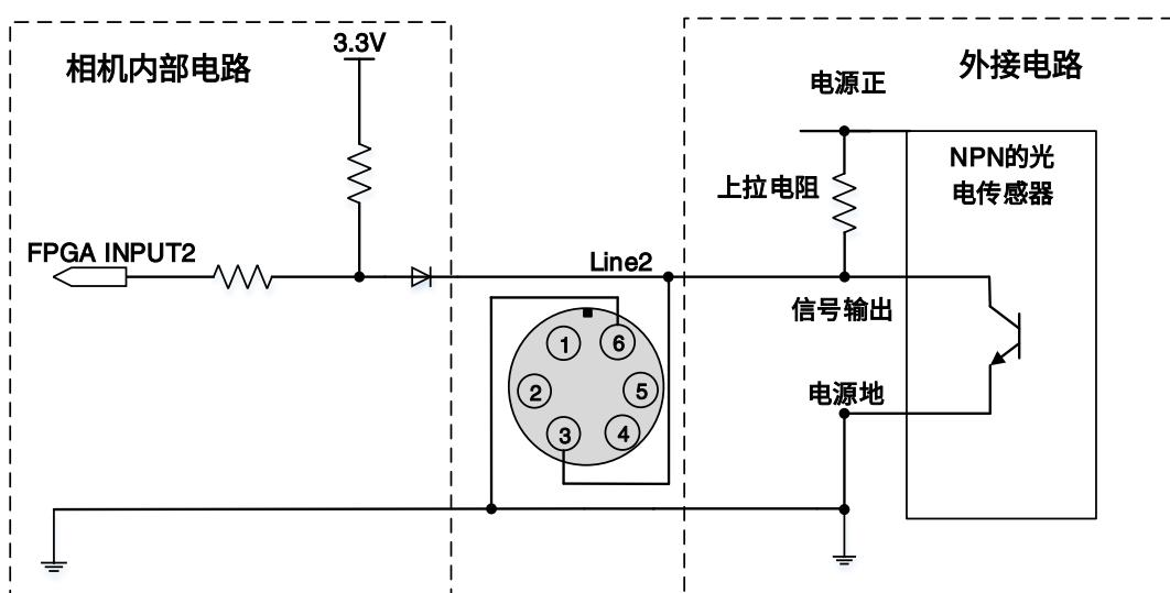
图 7-21 NPN 型光电传感器连接到 Line2 输入电路 (ME2S)
