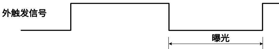
图 8-29 下降沿触发宽度曝光模式时序图
