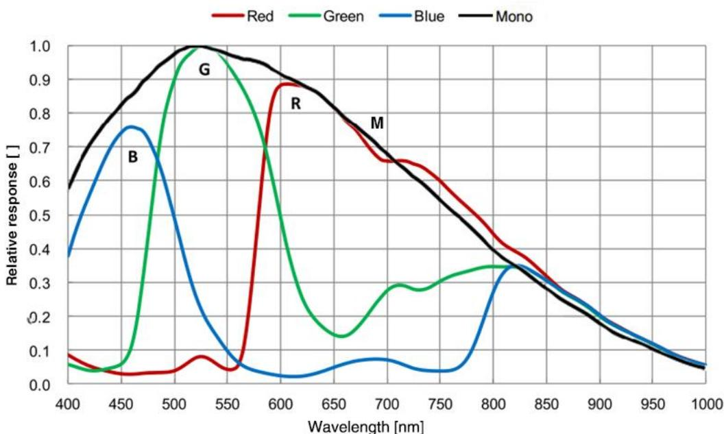
图 4-7 MER2-231-41U3M/C(-L) SENSOR 响应曲线
