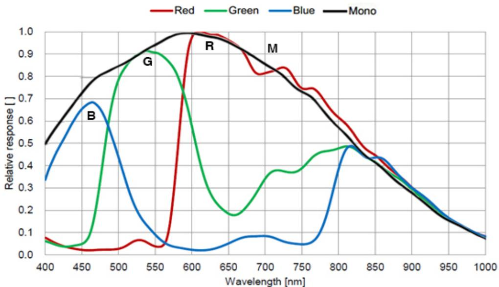
图 4-18 MER2-041-608U3M/C(-L)-HS SENSOR 响应曲线
