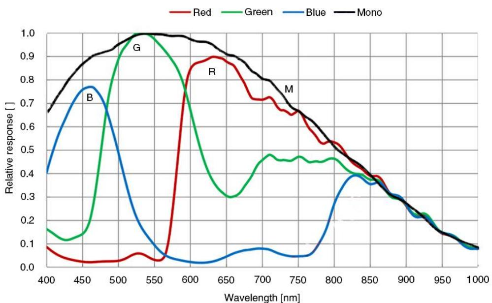
图 4-26 ME2S-2020-19U3M/C SENSOR 响应曲线
