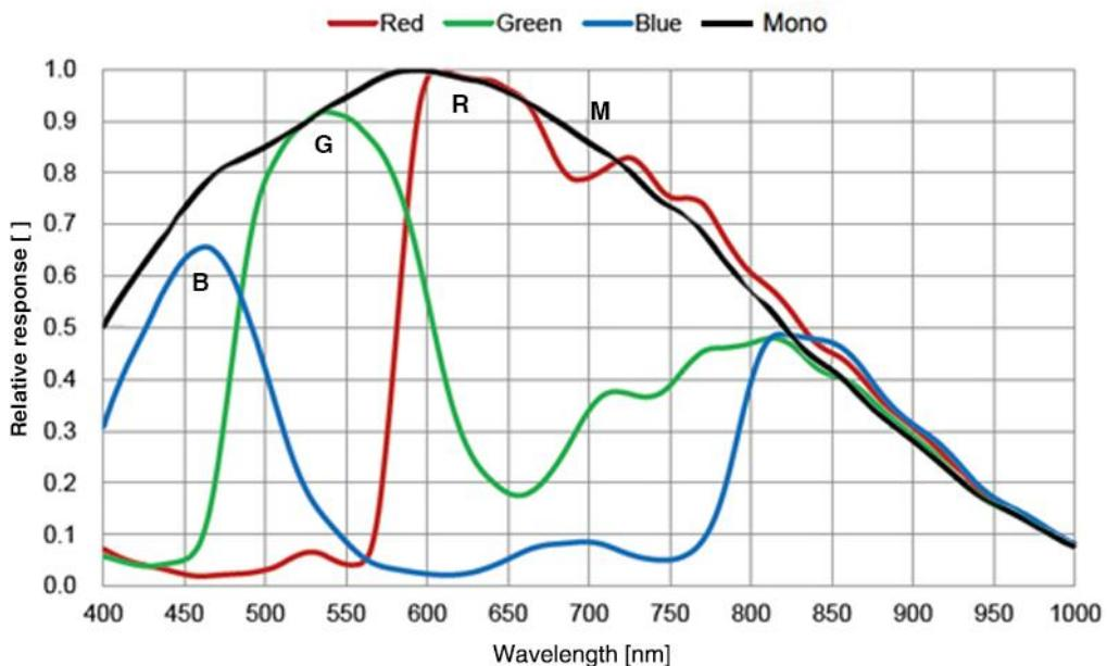
图 4-19 MER2-160-249U3M/C(-L)-HS SENSOR 响应曲线
