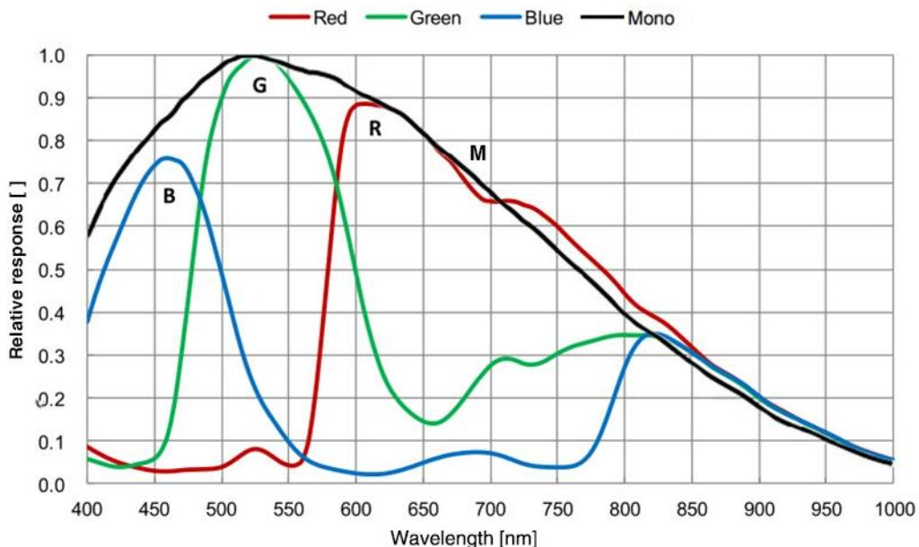
图 4-6 MER2-230-168U3M/C(-L) SENSOR 响应曲线
