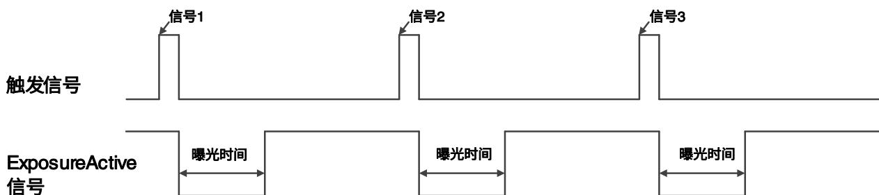
图 8-5 全局曝光模式 ExposureActive 信号示意图
