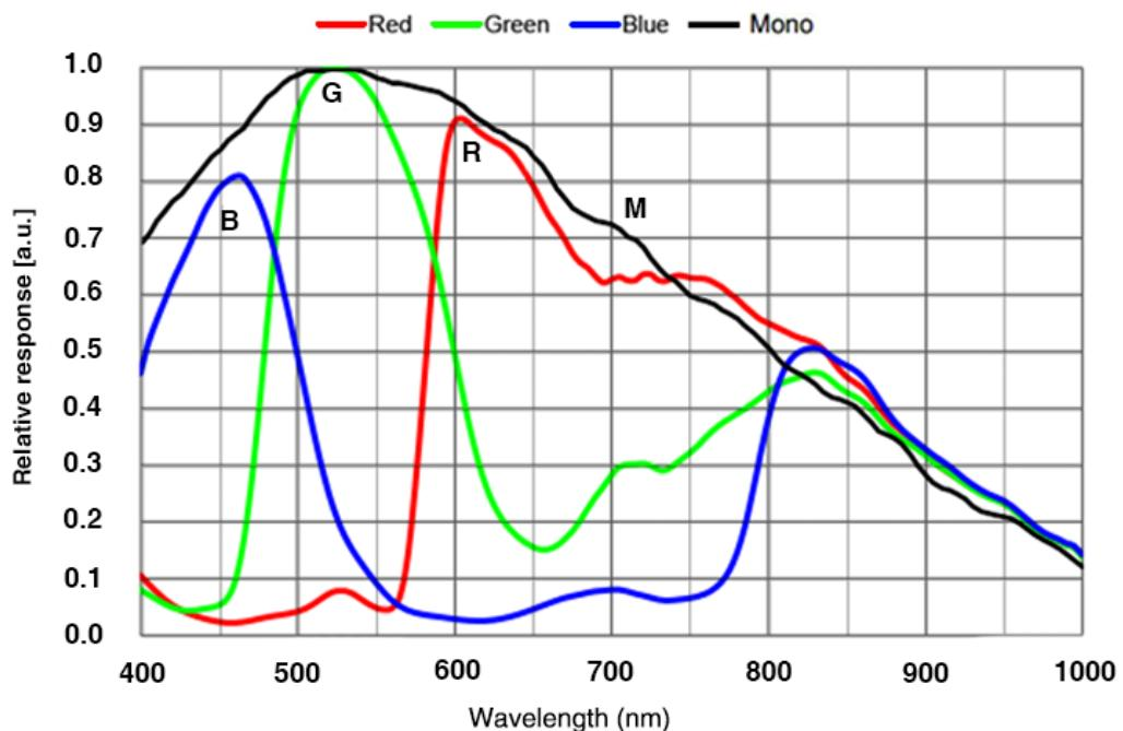
图 4-41 ME2L-505-36U3M/C(-L) SENSOR 响应曲线
