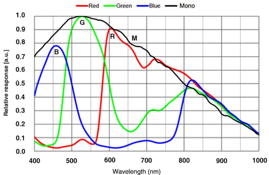
图 4-42 ME2L-830-22U3M/C(-L) SENSOR 响应曲线
