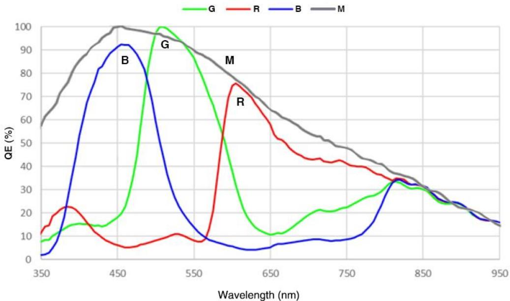
图 4-3 MER2-135-150U3M/C(-L) SENSOR 响应曲线
