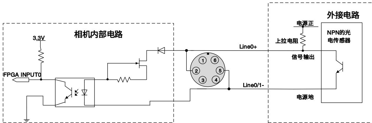
图 7-5 NPN 型光电传感器连接到光耦隔离输入电路 (ME2S)
