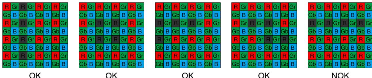
图 4-35 ME2P-2622-15U3C 连续坏点为相同颜色分量分布情况示意图
