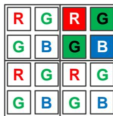
图 8-48 彩色相机水平垂直 Binning 系数 2x2
