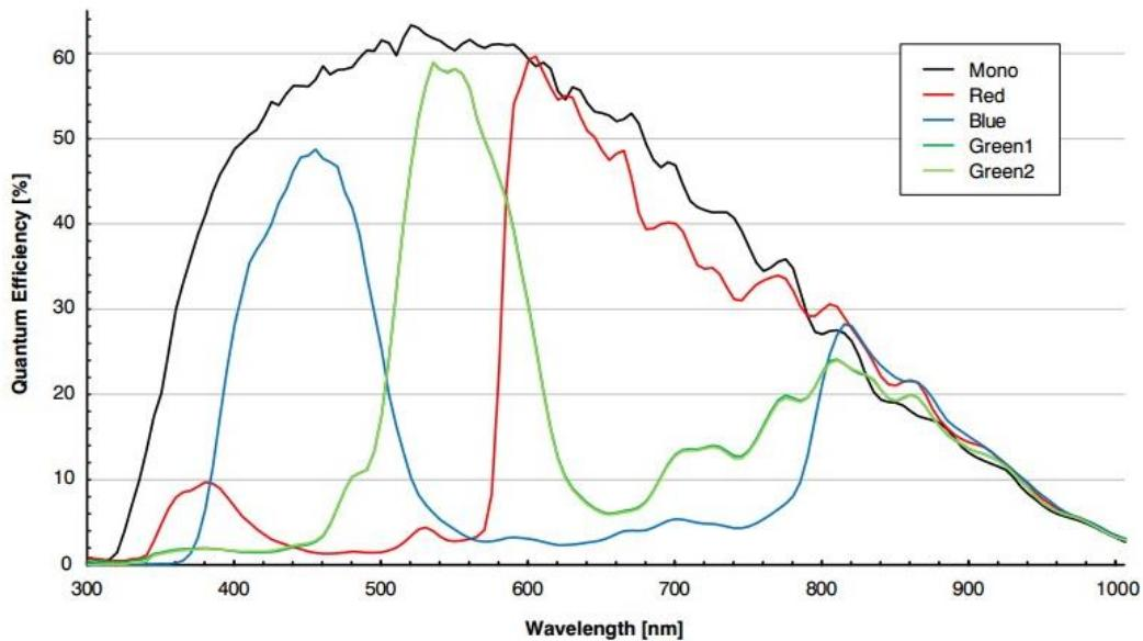
图 4-24 ME2S-1260-28U3M/C SENSOR 响应曲线
