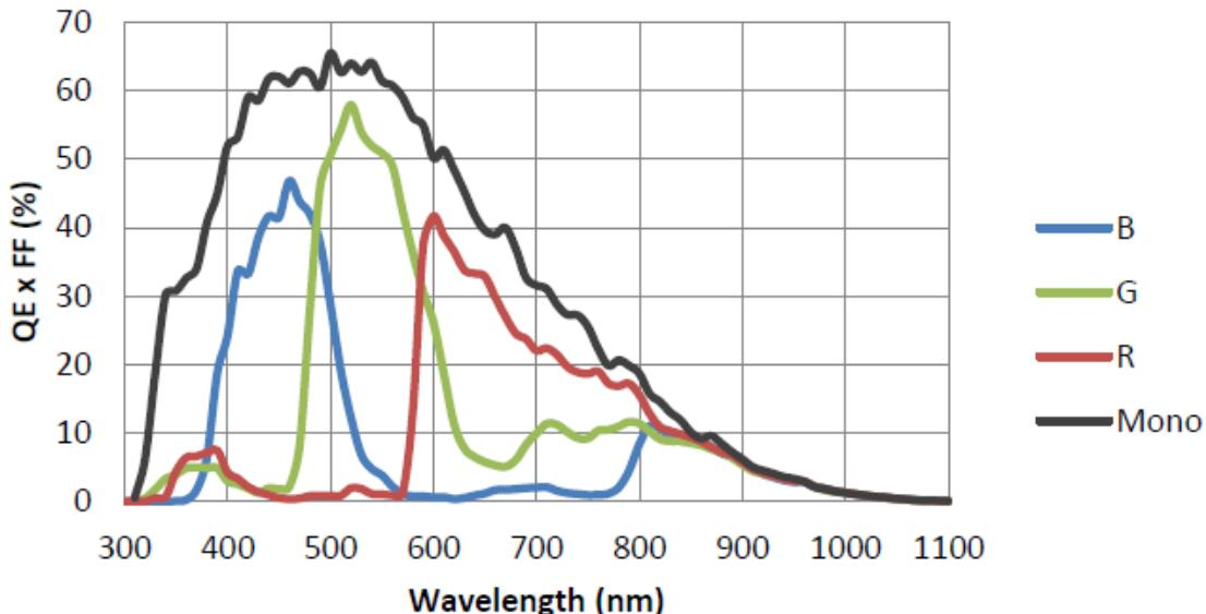
图 4-23 ME2S-560-70U3M/C SENSOR 响应曲线
