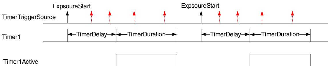
图 8-65 Timer1Active 与曝光开始信号的关系
