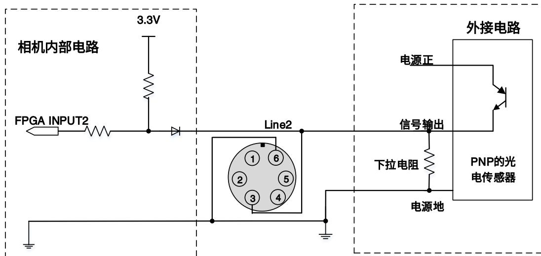
图 7-22 PNP 型光电传感器连接到 Line2 输入电路 (ME2S)
