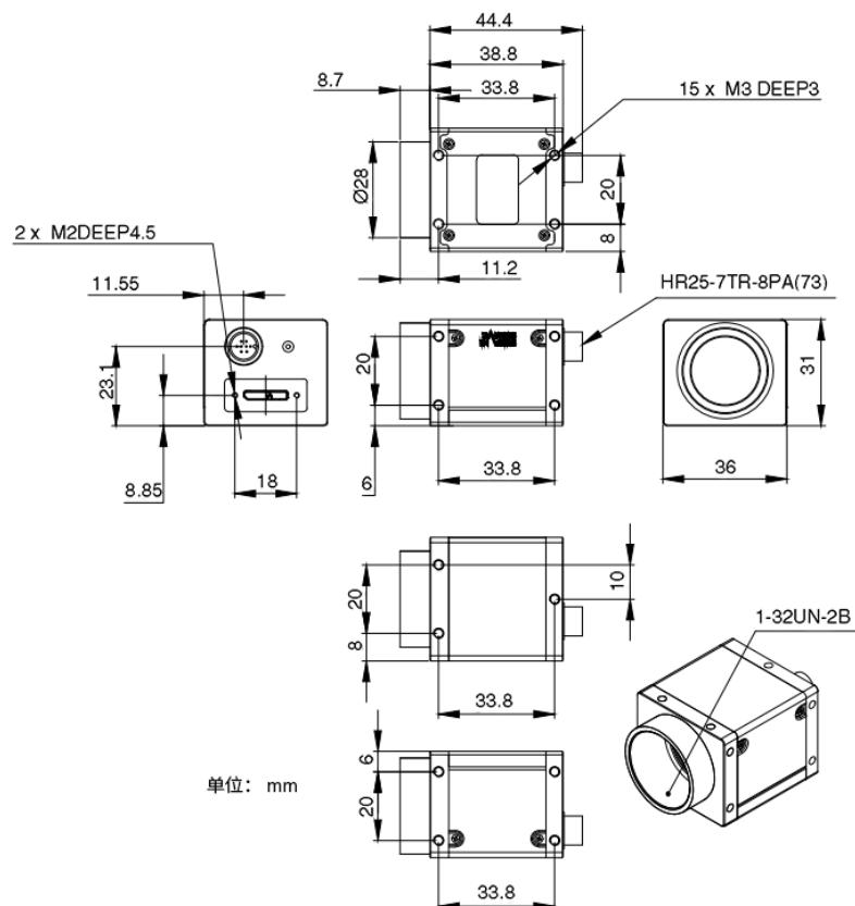
图 5-6 ME2P-U3 机械尺寸图
