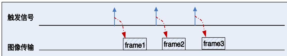
图 8-17 帧开始触发时序图
