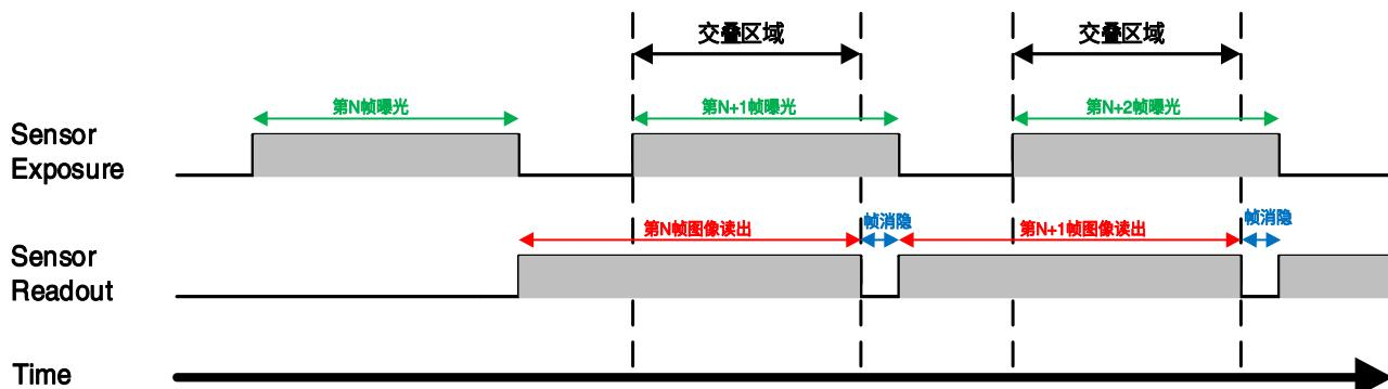
图 8-24 交叠曝光模式下曝光时序图
