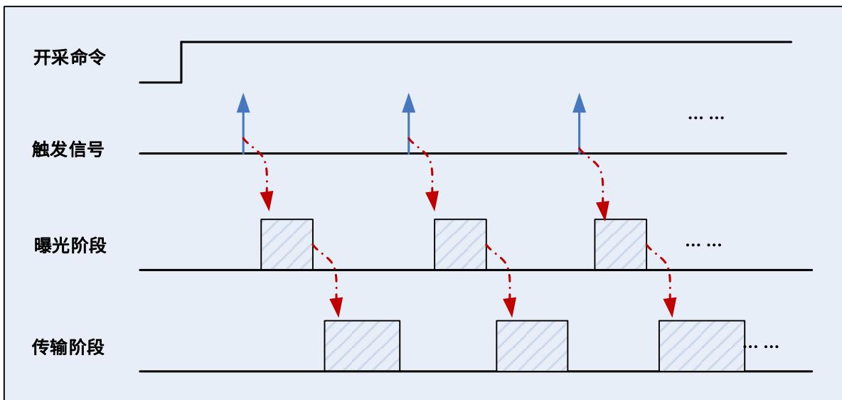
图 8-14 触发采集时序图
