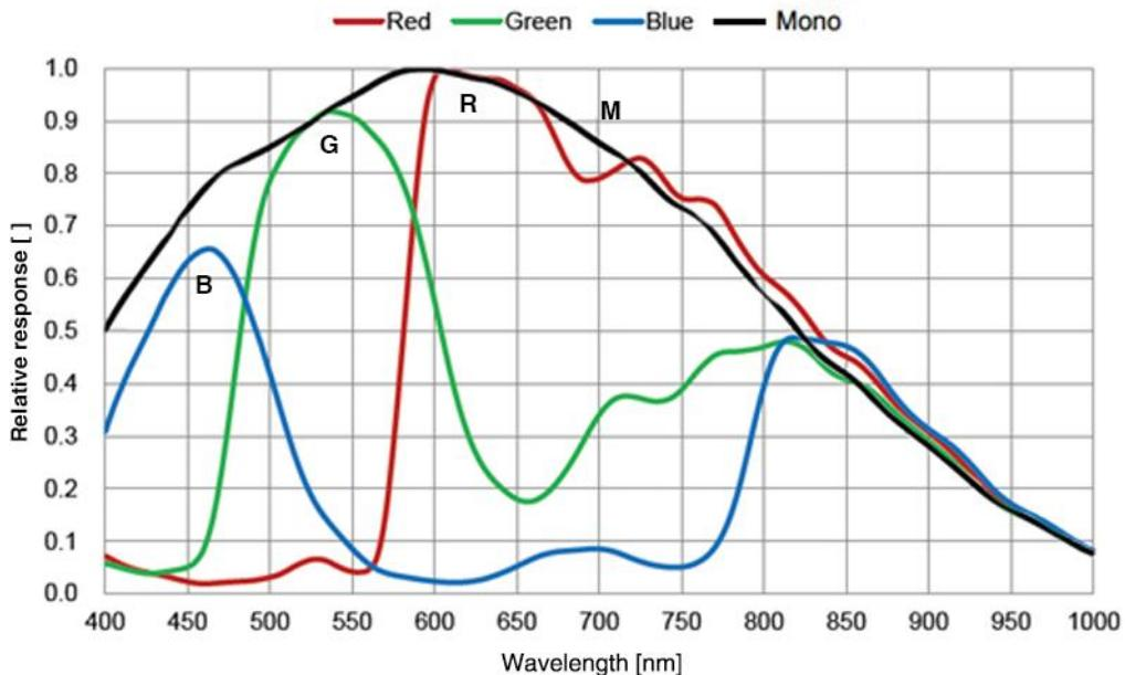
图 4-5 MER2-160-227U3M/C(-L) SENSOR 响应曲线
