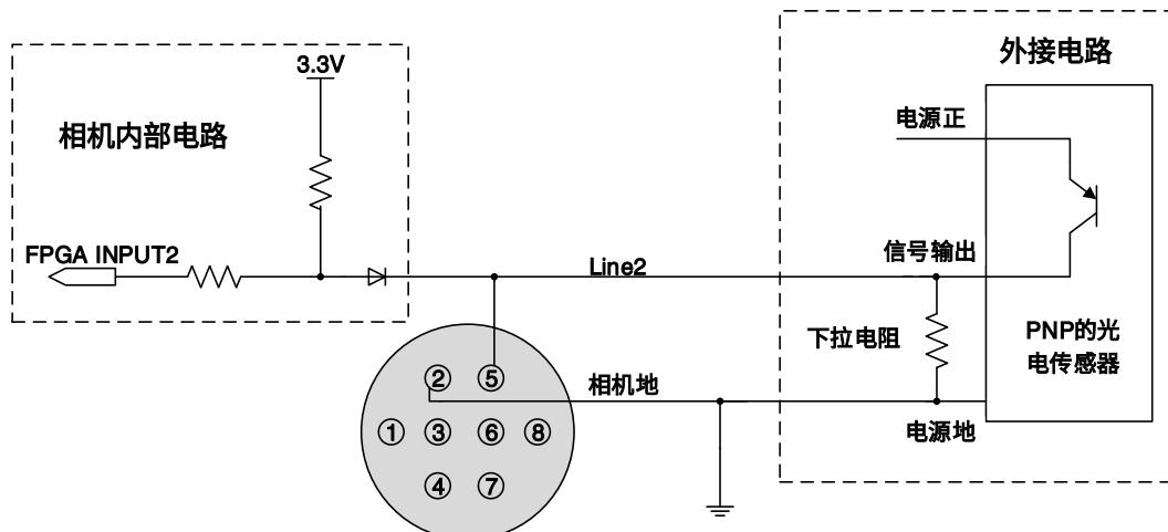
图 7-18 PNP 型光电传感器连接到 Line2 输入电路 (MER2/ME2P)
