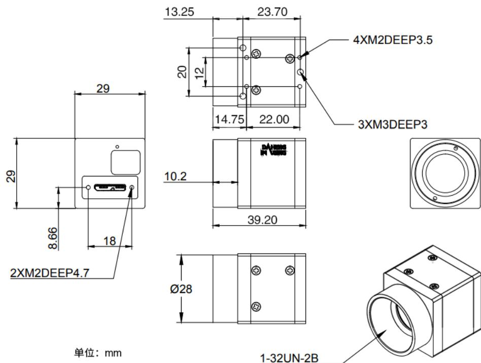
图 5-8 ME2L-U3-L 机械尺寸图
