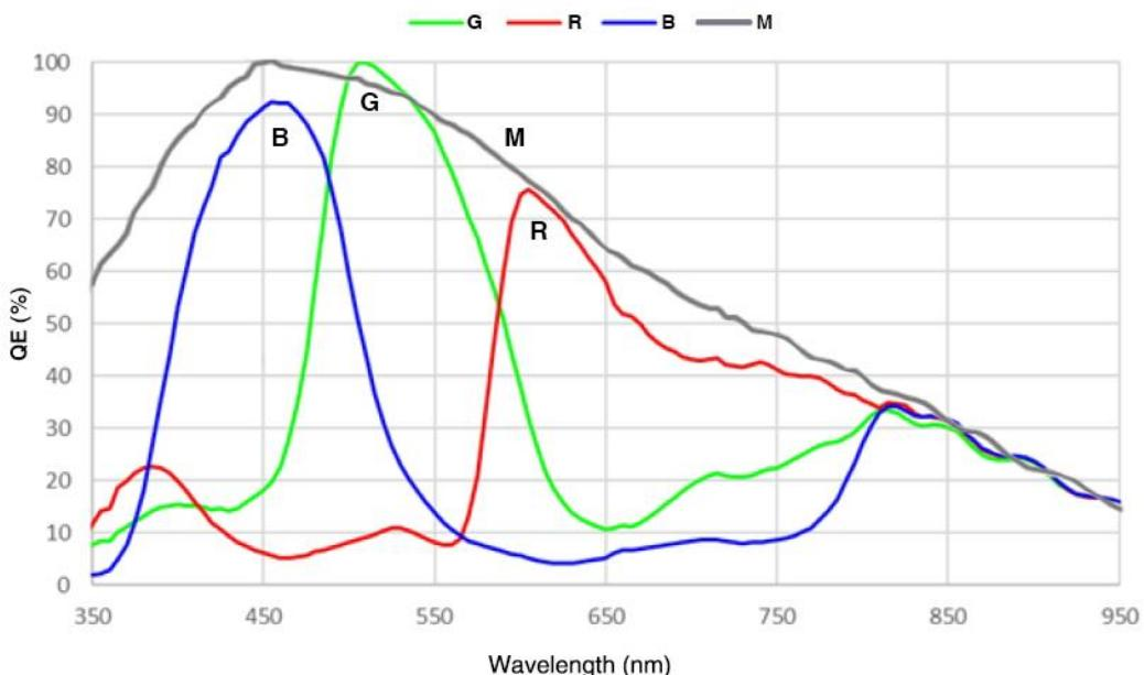
图 4-4 MER2-135-208U3M/C(-L) SENSOR 响应曲线
