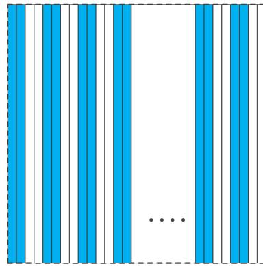
图 8-53 彩色相机水平像素抽样原理
