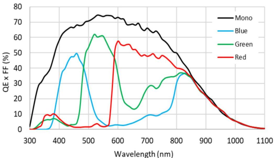
图 4-8 MER2-240-159U3M/C(-L) SENSOR 响应曲线
