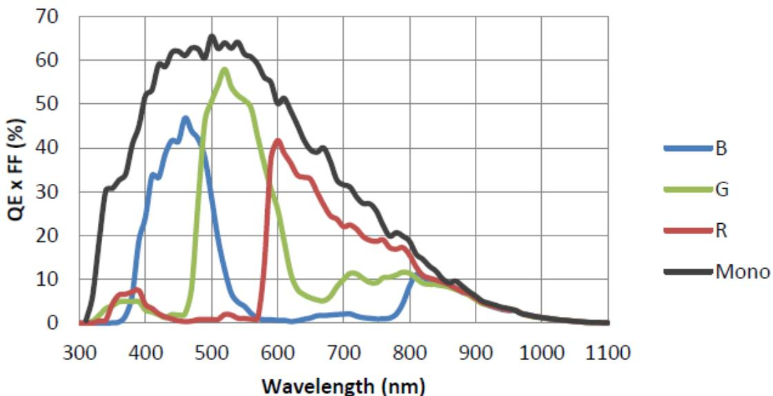
图 4-29 ME2P-900-43U3M/C SENSOR 响应曲线
