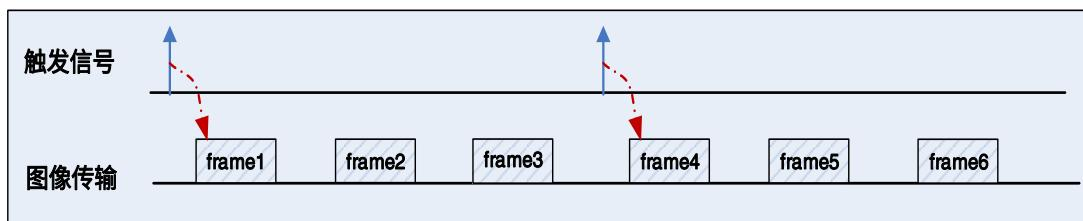
图 8-18 帧高速连拍开始触发时序图
