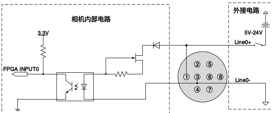
图 7-1 光耦隔离输入电路 (MER2/ME2P/ME2L)
