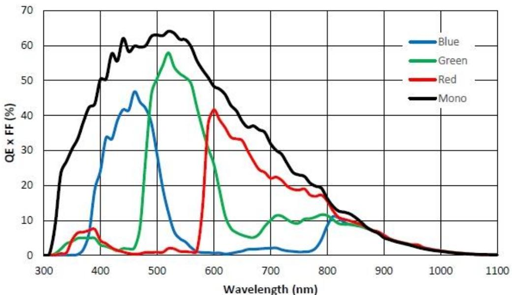
图 4-32 ME2P-1840-21U3M/C SENSOR 响应曲线
