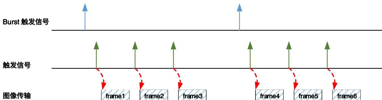
图 8-19 触发模式同时打开触发时序图
