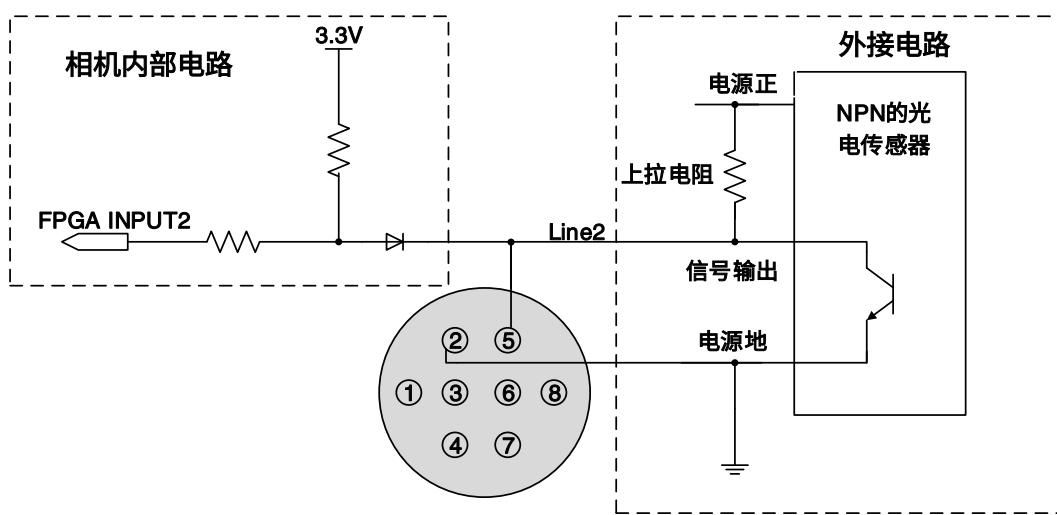
图 7-17 NPN 型光电传感器连接到 Line2 输入电路 (MER2/ME2P)
