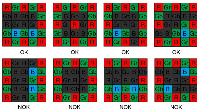
图 4-36 ME2P-2622-15U3C 连续坏点为不同颜色分量分布情况示意图
