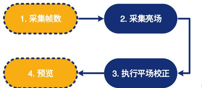
图 8-78 平场校正系数求取流程图
