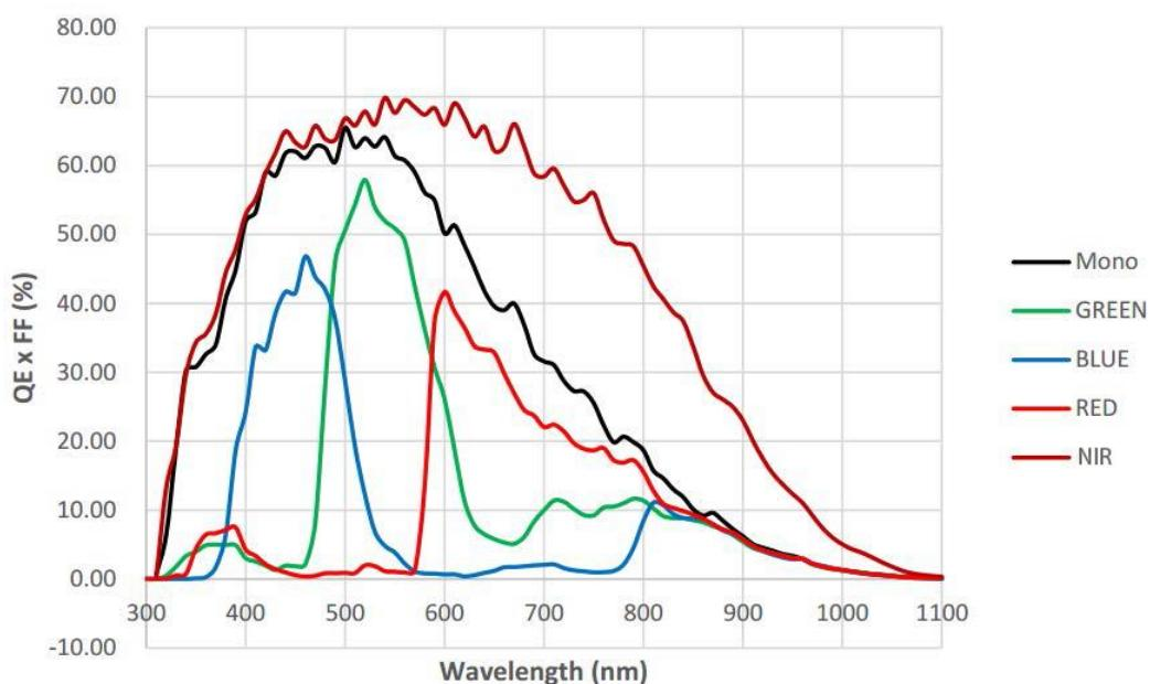
图 4-37 ME2P-2621-15U3M NIR \ ME2P-2622-15U3M NIR SENSOR 响应曲线
