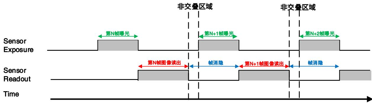
图 8-22 非交叠曝光模式下曝光时序图
