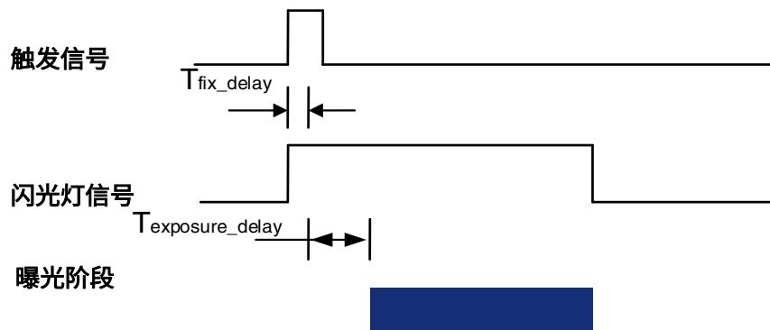
图 8-33 交叠曝光模式下曝光延迟时序图
