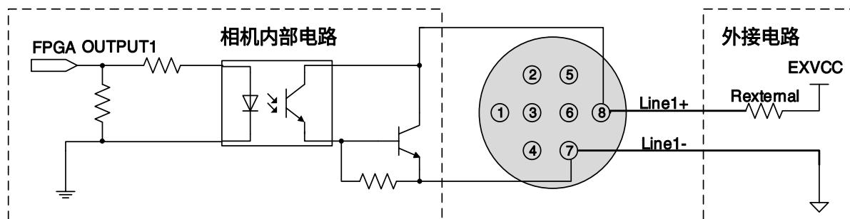
图 7-8 光耦隔离输出电路 (MER2/ME2P/ME2L)
