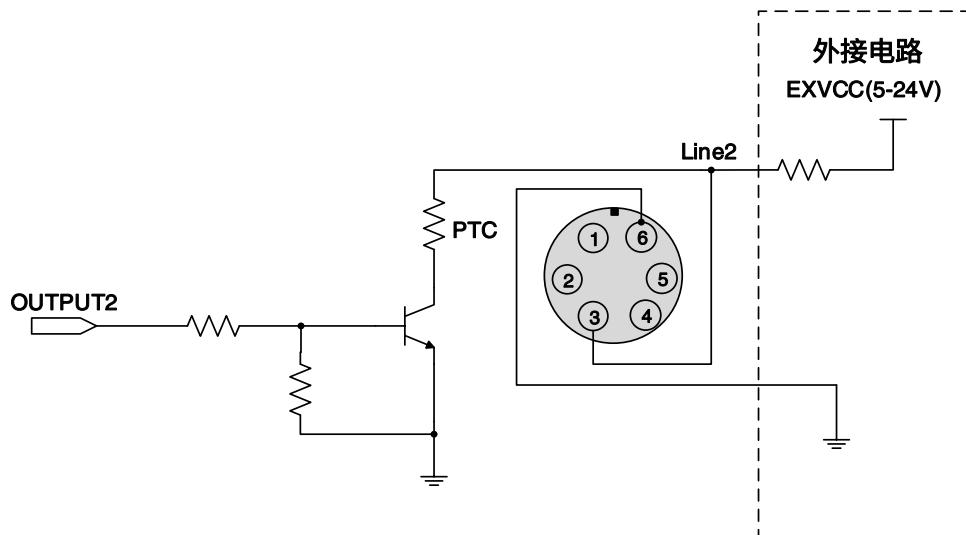
图 7-26 Line2 配置为输出引脚时相机内部等效电路 (ME2S)
