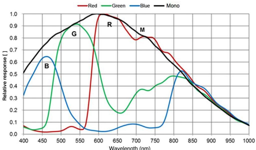
图 4-30 ME2P-1230-23U3M/C SENSOR 响应曲线
