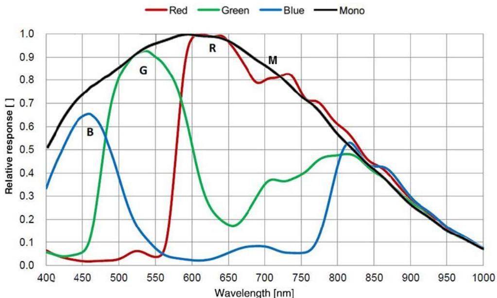
图 4-11 MER2-502-79U3M/C(-L) SENSOR 响应曲线
