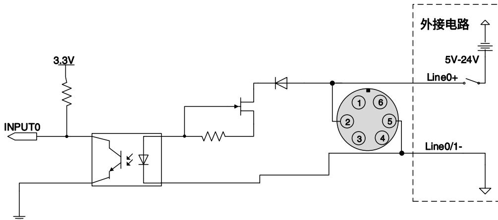
图 7-2 光耦隔离输入电路 (ME2S)
