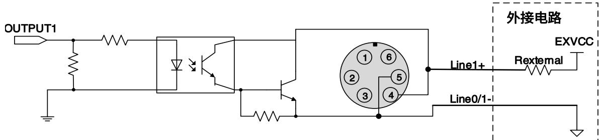
图 7-9 光耦隔离输出电路 (ME2S)
