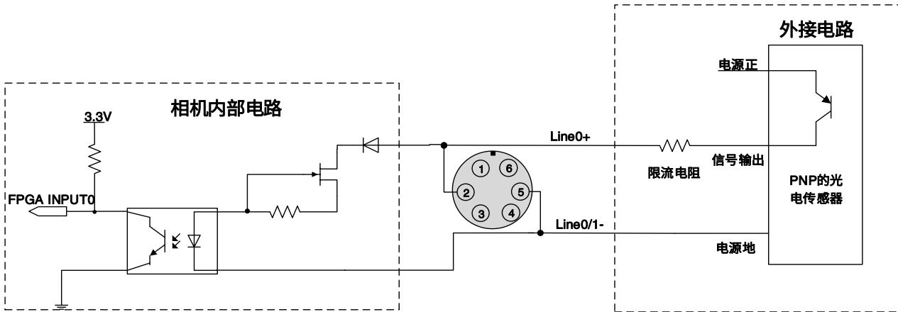
图 7-6 PNP 型光电传感器连接到光耦隔离输入电路 (ME2S)
