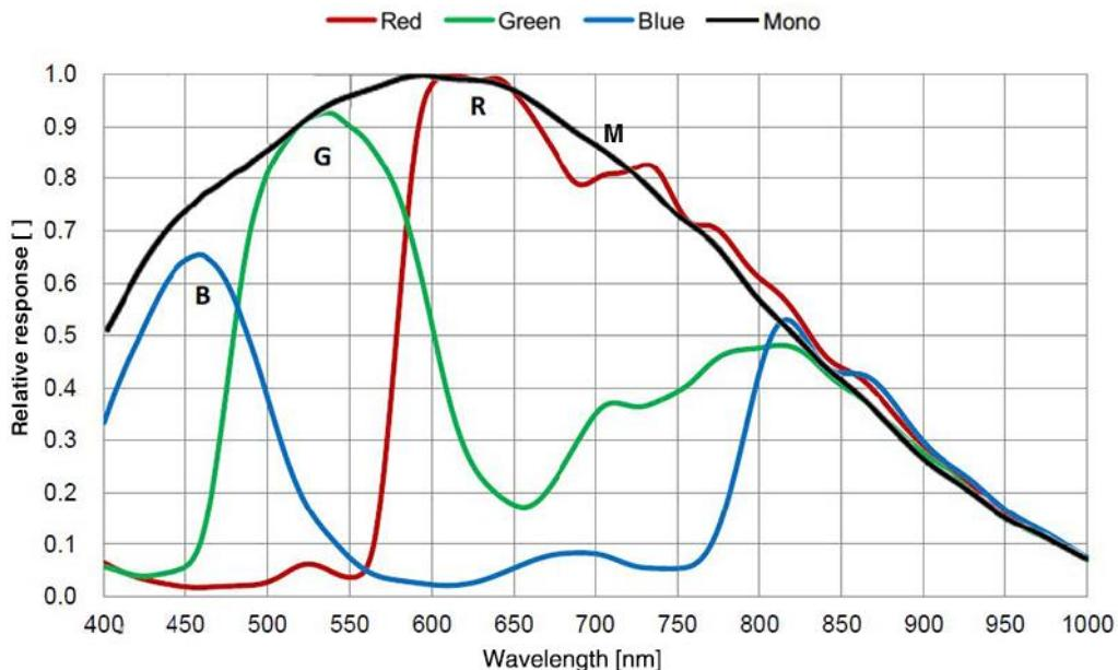
图 4-21 MER2-502-79U3M/C(-L)-HS SENSOR 响应曲线
