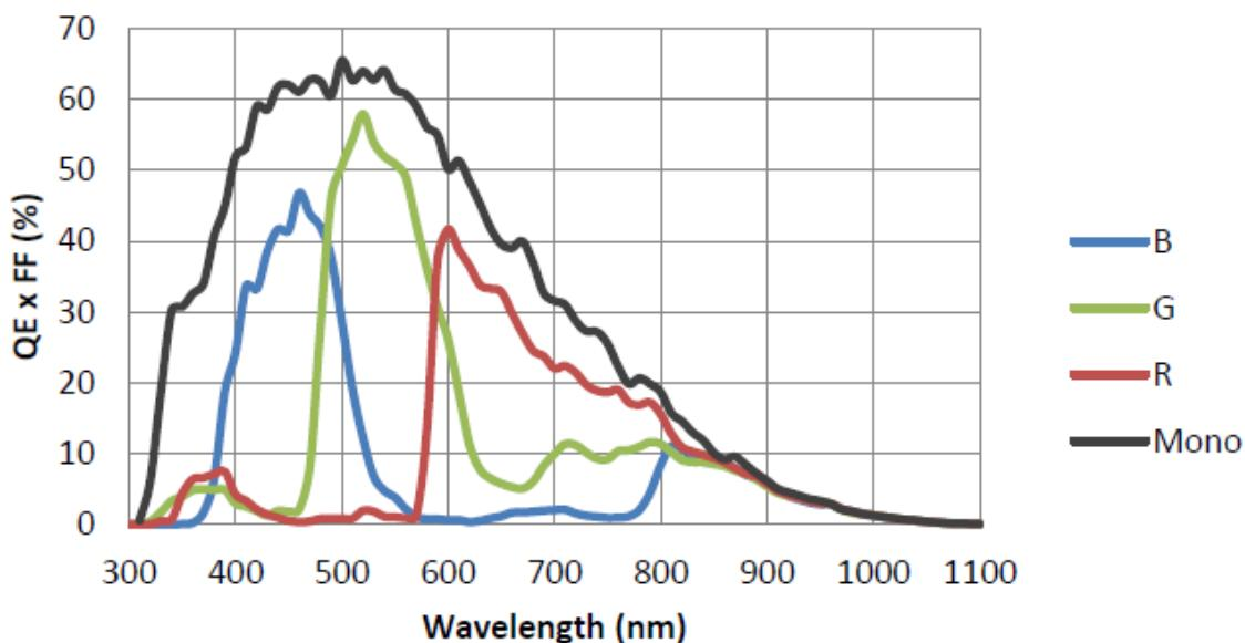
图 4-28 ME2P-560-36U3M/C SENSOR 响应曲线
